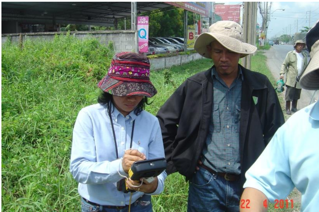
ภาพที่ ๒ - ๘ แสดงการตรวจสอบการสื่อสารเครื่องรับสัญญาณดาวเทียม (Rover) กับระบบโครงข่ายฯ
