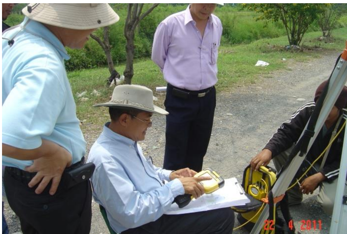
ภาพที่ ๒ - ๑๔ แสดงการเก็บข้อมูลการรังวัดหมุดหลักฐานแผนที่ (หมุดดาวเทียม RTK Network)
