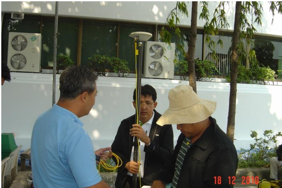
ภาพที่ ๒ - ๑๓ แสดงการยืนถือหลักขาวแดง (Pole) ซึ่งมีเป้าปริซึมหรือจานรับสัญญาณดาวเทียมตั้งอยู่
