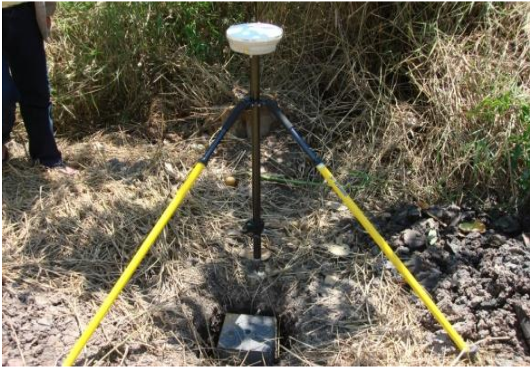
ภาพที่ ๒ - ๑๒ แสดงสภาพพื้นที่บังคับ ให้วางหลักขาวแดงบนขาตั้ง (Bipod)
