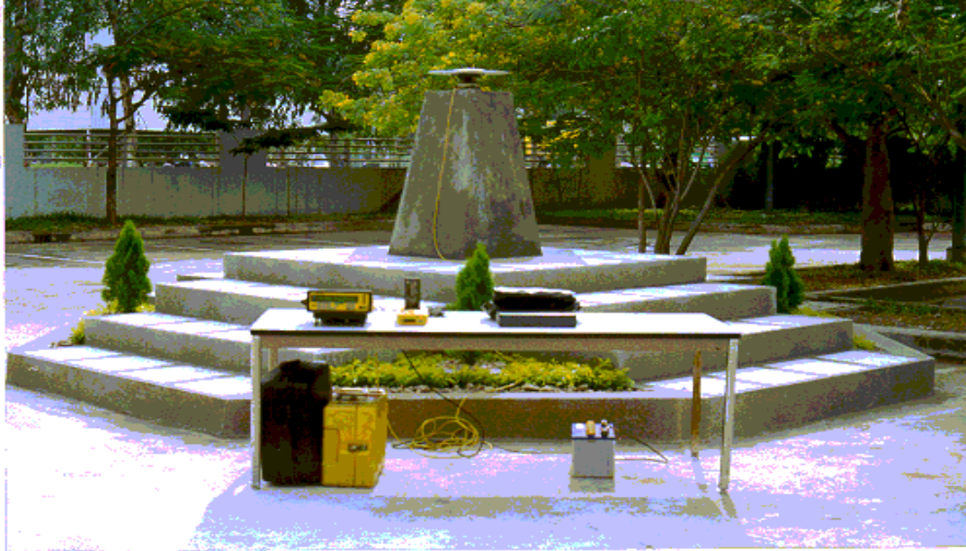
ภาพที่ ๒ - ๙ แสดงการตรวจสอบเครื่องรับสัญญาณดาวเทียม ณ หมวดหลักฐานแผนที่ ซึ่งทราบค่าพิกัด
