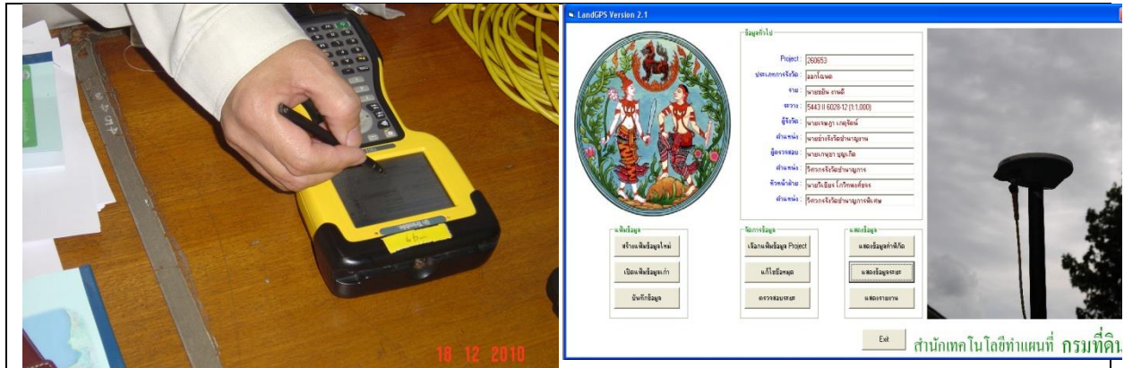
ภาพที่ ๒ - ๑๕ แสดงการนำข้อมูลการรังวัดด้วยระบบโครงข่ายฯ ถ่ายทอดข้อมูลการรังวัดด้วยโปรแกรม LandGPS
