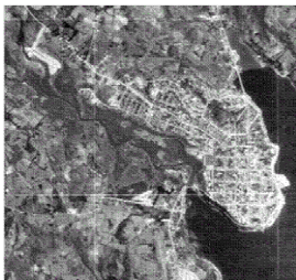
ระดับความเข้มของสีที่แตกต่างกันบนภาพถ่ายทางอากาศ
