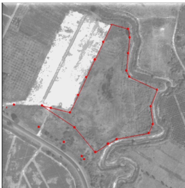
ภาพที่ ๑๒ การสร้างรูปแบบที่ดิน จากการรังวัดค่าพิกัดฯ ด้วยเครื่องรับสัญญาณดาวเทียม
