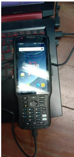
ทำการต่อสาย USB ระหว่างเครื่อง TC50 เข้ากับคอมพิวเตอร์
