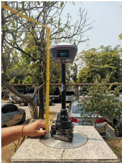
การวัดความสูงแบบ Vertical วัดถึงขอบบนของหัว Receiver
