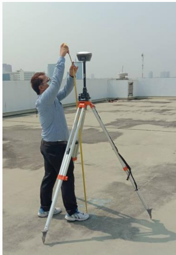
การวัดความสูงแบบ Slant วัดถึง Plate
