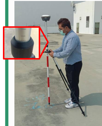
การวัดความสูงแบบ Pole (เฉพาะ Pole ของ Tersus เท่านั้น ระยะอ่านจริง ลบด้วย 10 cm.)
