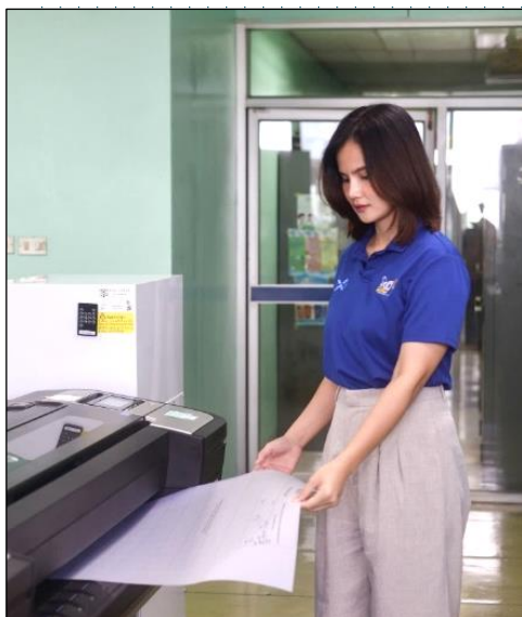
ภาพที่ ๒๖ การพิมพ์ข้อมูลรูปแปลงที่ดินลงบนแผ่นทาบระวาง (Overlay) ด้วยเครื่องพิมพ์ (Plotter)
