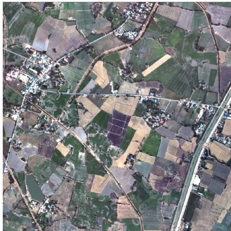
ภาพที่ ๓ ตัวอย่างระวางแผนที่ภาพถ่ายทางอากาศเชิงเลข (DMC) มาตรฐาน ๑ : ๔,๐๐๐
