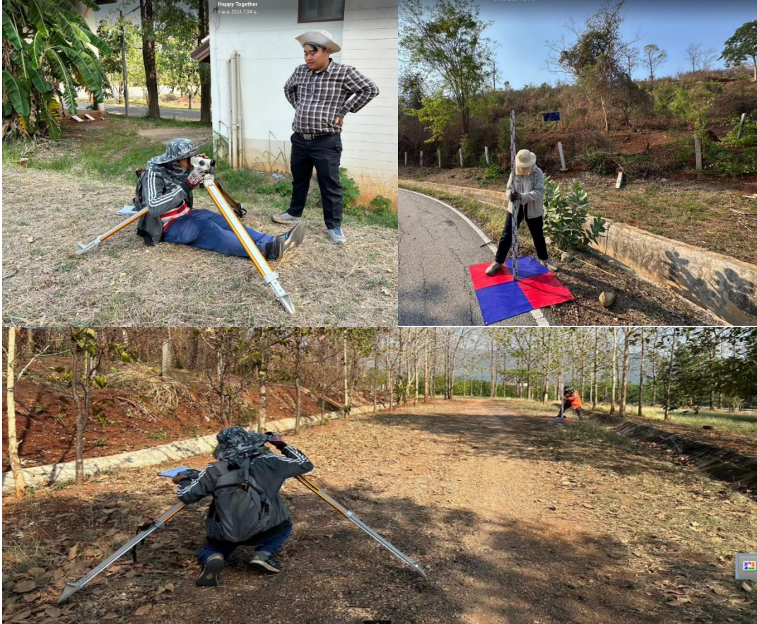
ภาพที่ ๒๙ การรังวัดระดับด้วยกล้องระดับ Automatic level
