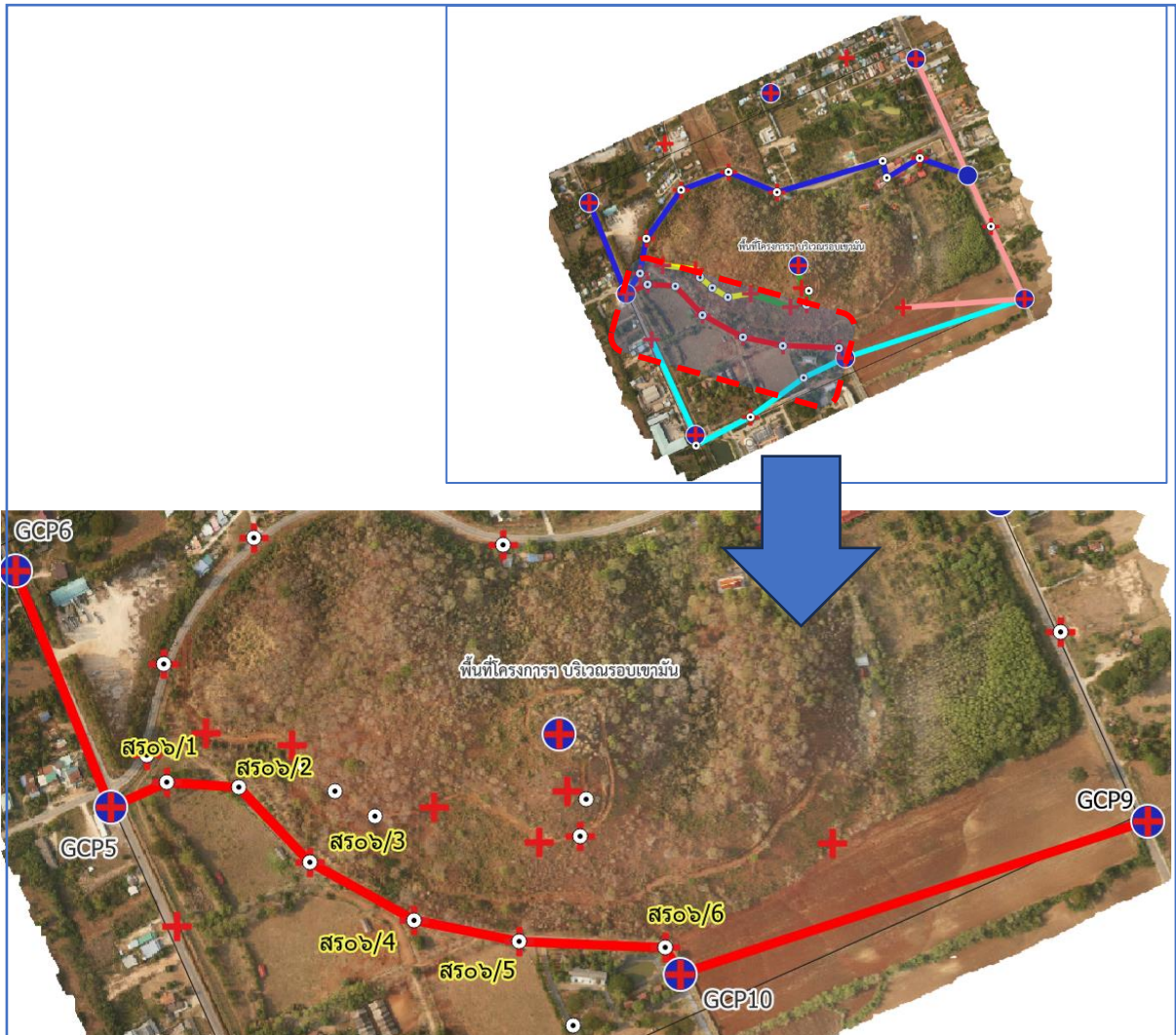
ภาพที่ ๑๙ ตำแหน่งเส้นโครงงานหมุดหลักฐานแผนที่ เพื่อเก็บรายละเอียด ชื่อเส้น สร๐๖
