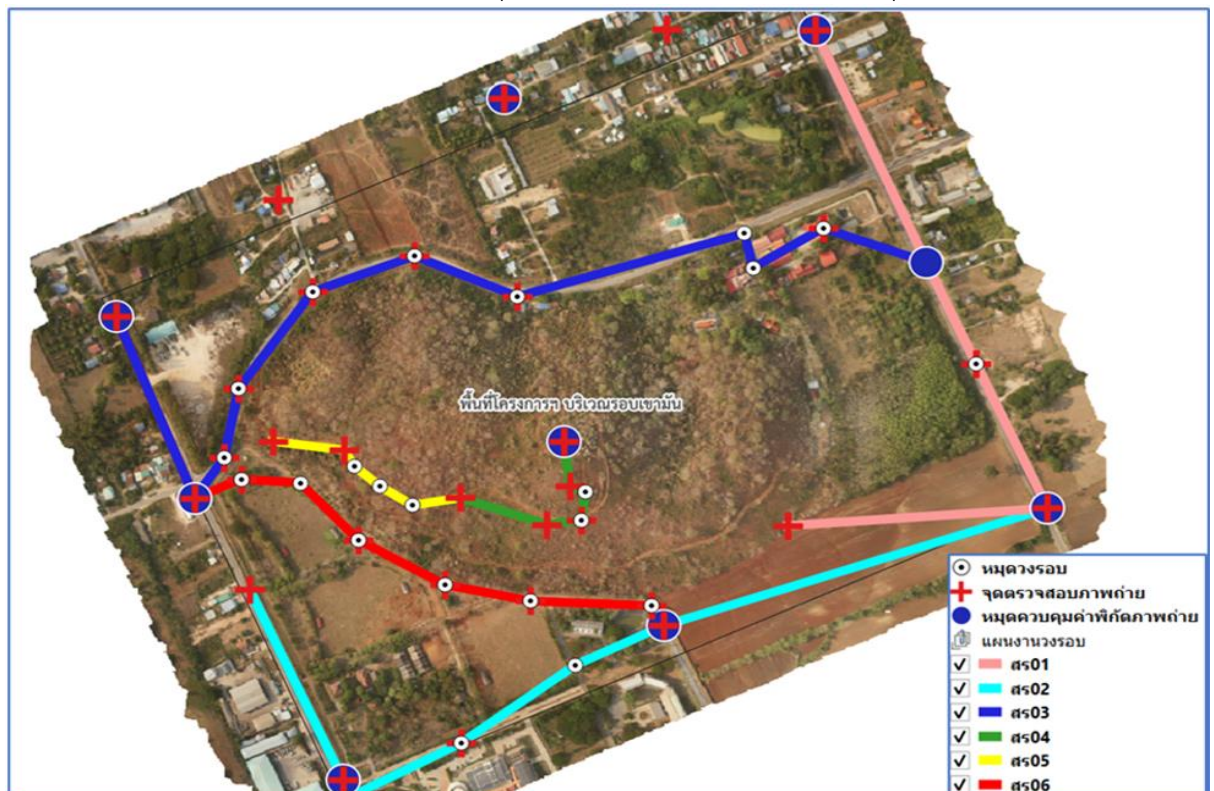
ภาพที่ ๗ การวางแผนงานหมุดตรวจสอบภาพถ่าย
