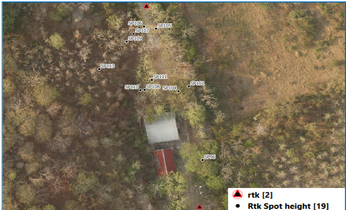
ภาพที่ ๒๖ ตำแหน่งจุดตรวจสอบระดับ RTK SP (RTK Spot height)
