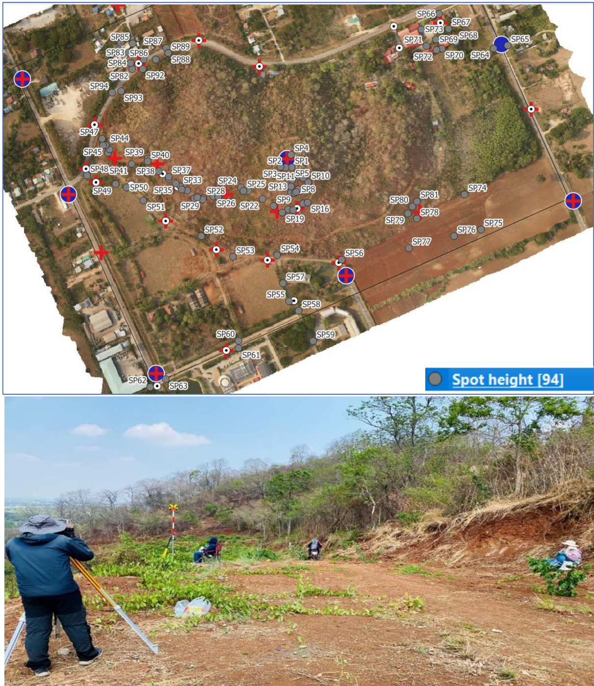
ภาพที่ ๒๔ การรังวัดจุดตรวจสอบระดับ SP (Spot height)
