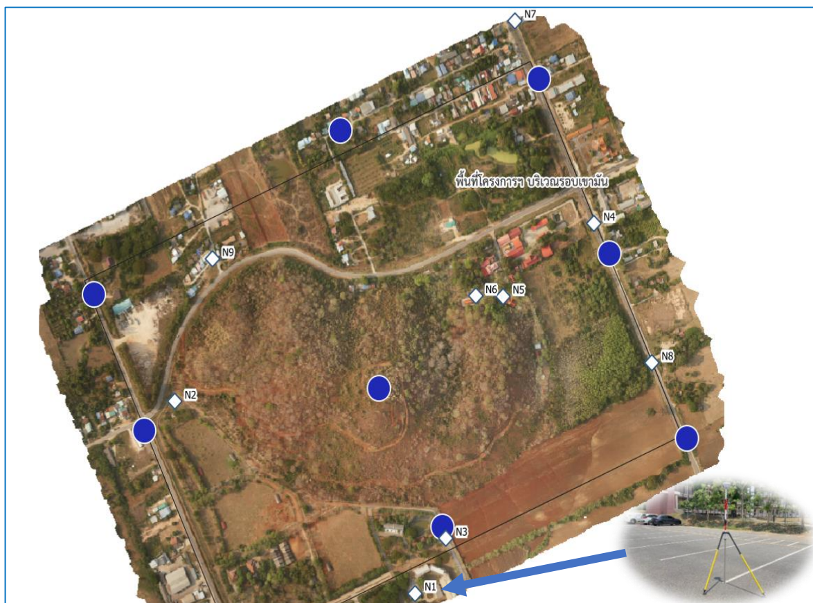
ภาพที่ ๒๗ ตำแหน่งจุดตรวจสอบค่าพิกัดภาพ ที่มีอยู่ตามธรรมชาติก่อนการบินภาพ UAV
