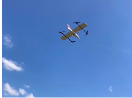
ภาพที่ ๔ การบินถ่ายภาพทางอากาศด้วยอากาศยานไร้คนขับประเภทปีกตรึงขึ้นลงแนวตั้ง
