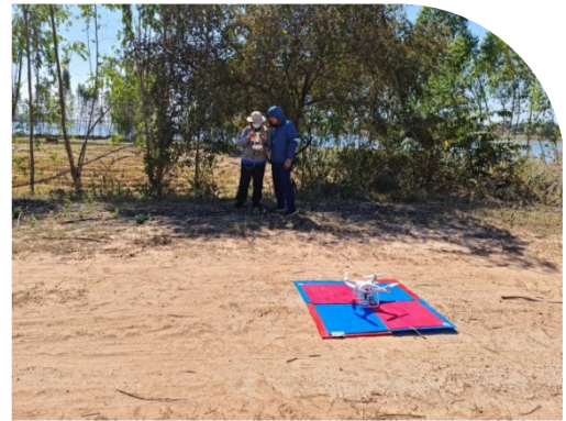
ภาพที่ ๔ การบินถ่ายภาพทางอากาศด้วยอากาศยานไร้คนขับประเภทปีกตรึงขึ้นลงแนวตั้ง
