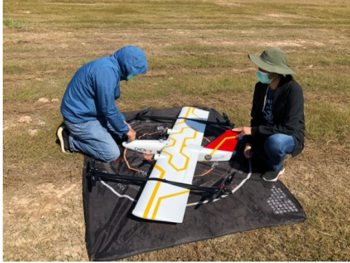
ภาพที่ ๔ การบินถ่ายภาพทางอากาศด้วยอากาศยานไร้คนขับประเภทปีกตรึงขึ้นลงแนวตั้ง
