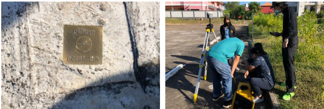
ภาพที่ ๒ การรังวัดหมุดตรวจสอบ
