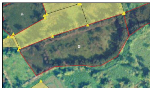
รูปที่ ๘๑ เปรียบเทียบรูปแปลงที่ดินที่มาจากการแปลงค่าพิกัด กับระวางแผนที่รูปถ่ายทางอากาศ DMC
