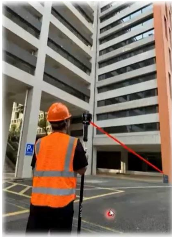
รูปที่ ๑๔ รูปแสดงการรังวัดระบบเลเซอร์สแกนเนอร์ (Laser Scanner) SLAM + RTK
