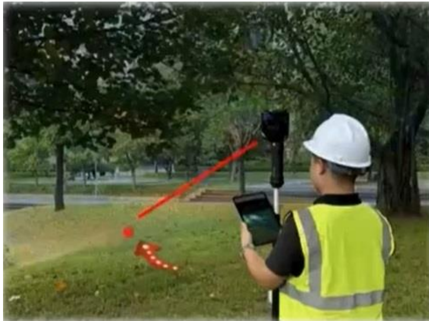
รูปที่ ๑๔ รูปแสดงการรังวัดระบบเลเซอร์สแกนเนอร์ (Laser Scanner) SLAM + RTK
