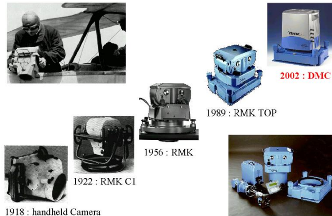
รูปที่ ๑ พัฒนาการของกล้องถ่ายภาพทางอากาศของ Zeiss
