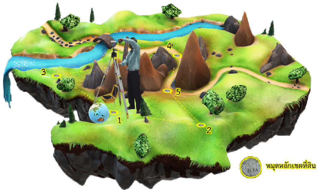
รูปภาพแสดงวิธีการรับสัญญาณดาวเทียมที่หัวหมุดหลักเขตที่ดิน
