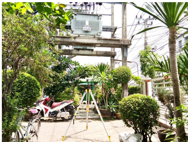
รูปภาพแสดงตำแหน่งใกล้หม้อแปลงไฟฟ้า ซึ่งเป็นตำแหน่งที่ไม่เหมาะสมในการรับสัญญาณดาวเทียม
