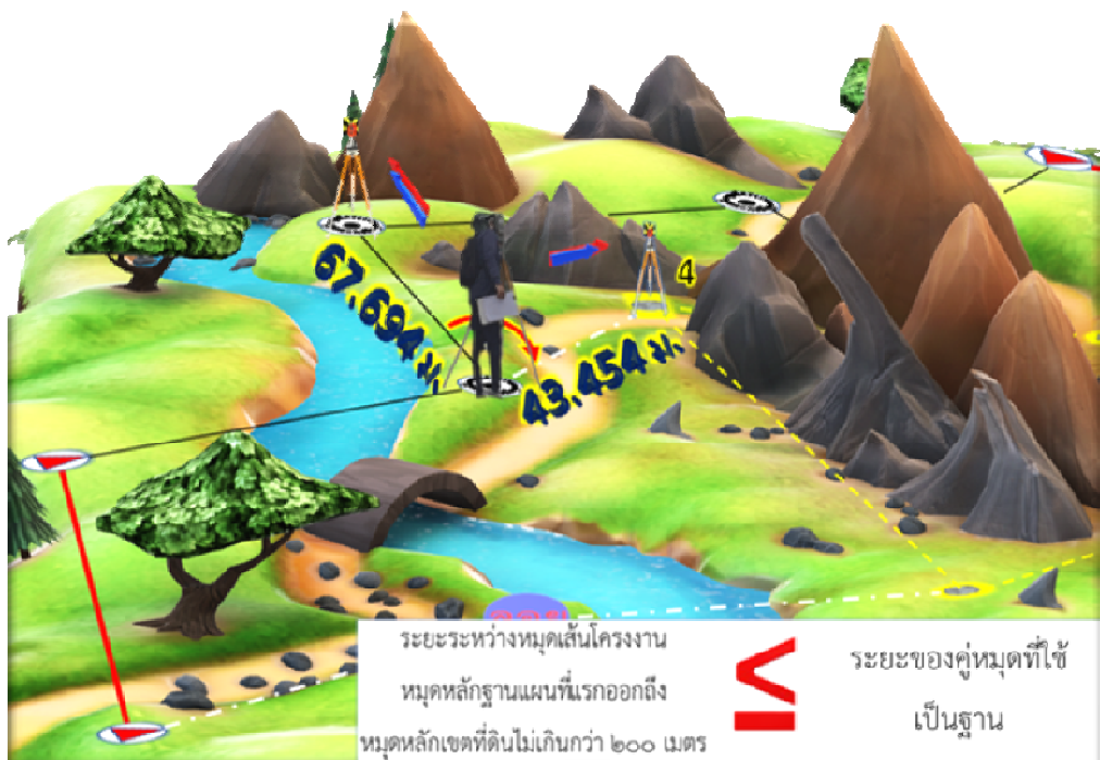
รูปภาพแสดงการโยงียึดหมุดหลักเขตที่ดินจากหมุดเส้นโครงงานหมุดหลักฐานแผนที่
