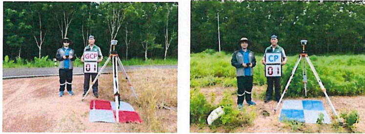
ภาพที่ ๓.๑๘ การสร้างจุดควบคุมภาคพื้นดิน (GCP) และจุดตรวจสอบ (CP)
