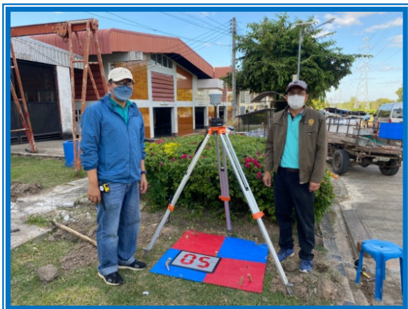
ภาพที่ ๓.๒๑ การสร้างจุดควบคุมภาคพื้นดิน (GCPs) และจุดตรวจสอบ (CPs)
