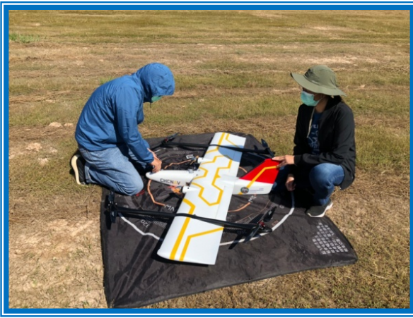
ภาพที่ ๓.๒๒ การบินถ่ายภาพทางอากาศด้วยอากาศยานไร้คนขับประเภทปีกตรึงขึ้นลงแนวดิ่ง
