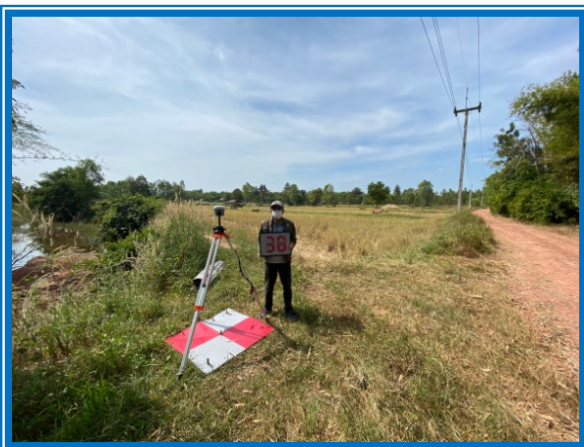
ภาพที่ ๓.๒๑ การสร้างจุดควบคุมภาคพื้นดิน (GCPs) และจุดตรวจสอบ (CPs)
