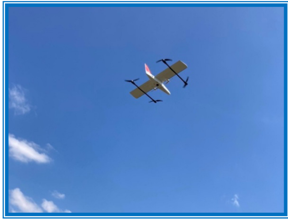
ภาพที่ ๓.๒๒ การบินถ่ายภาพทางอากาศด้วยอากาศยานไร้คนขับประเภทปีกตรึงขึ้นลงแนวดิ่ง
