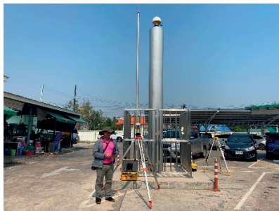
ภาพที่ 2-2 การสร้างจุดควบคุมภาคพื้นดิน (GCPs) จำนวน 146 จุด และจุดตรวจสอบ (CPs) จำนวน 89 จุด ในพื้นที่จากอำเภอเด่นชัย จังหวัดแพร่ ถึงอำเภองาว จังหวัดลำปาง
