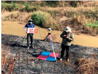
ภาพที่ 2-2 การสร้างจุดควบคุมภาคพื้นดิน (GCPs) จำนวน 146 จุด และจุดตรวจสอบ (CPs) จำนวน 89 จุด ในพื้นที่จากอำเภอเด่นชัย จังหวัดแพร่ ถึงอำเภองาว จังหวัดลำปาง
