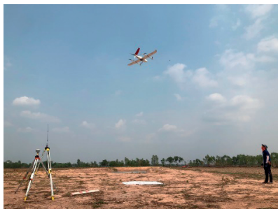
ภาพที่ 3-3 การบินถ่ายภาพทางอากาศด้วยอากาศยานไร้คนขับ จำนวน 28 บล็อก พื้นที่อำเภอบรบือ จังหวัดมหาสารคาม ถึงอำเภอหนองพอก จังหวัดร้อยเอ็ด
