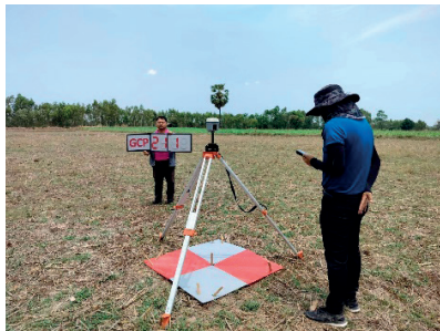
ภาพที่ 2-3 การสร้างจุดควบคุมภาคพื้นดิน (GCPs) จำนวน 245 จุด และจุดตรวจสอบ (CPs) จำนวน 131 จุด พื้นที่อำเภอบรบือ จังหวัดมหาสารคาม ถึงอำเภอหนองพอก จังหวัดร้อยเอ็ด
