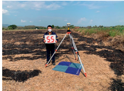
ภาพที่ 2-2 การสร้างจุดควบคุมภาคพื้นดิน (GCPs) จำนวน 146 จุด และจุดตรวจสอบ (CPs) จำนวน 89 จุด ในพื้นที่จากอำเภอเด่นชัย จังหวัดแพร่ ถึงอำเภองาว จังหวัดลำปาง
