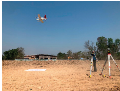
ภาพที่ 3-2 การบินถ่ายภาพทางอากาศด้วยอากาศยานไร้คนขับ จำนวน 19 บล็อก ในพื้นที่จากอำเภอเด่นชัย จังหวัดแพร่ ถึงอำเภองาว จังหวัดลำปาง
