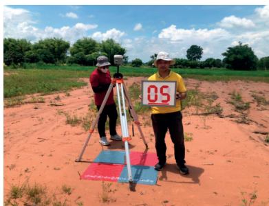
ภาพที่ 2.-1 การสร้างจุดควบคุมภาคพื้นดิน (GCPs) จำนวน 53 จุด และจุดตรวจสอบ (CPs) จำนวน 36 จุดในพื้นที่สถานีชุมทางบ้านหนองแขงไร่ (อำเภอบ้านไผ่)- ภูเหล็ก-นาโพธิ์-กุตุรง-อำเภอบรบือ
