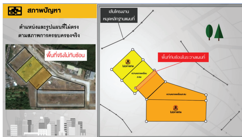
รูปภาพที่ ๑ ตัวอย่างปัญหารูปแปลงที่ดินในระวางแผนที่ที่มีตำแหน่งไม่สอดคล้องกับสภาพการครอบครองในพื้นที่จริง
