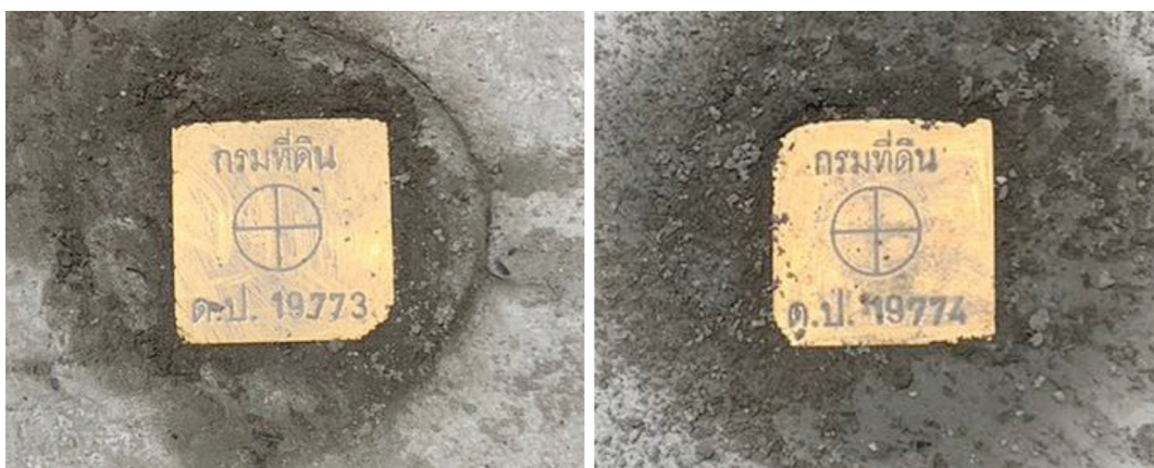
ภาพที่ ๒ แสดงหมุดทองเหลือง (ด.ป.) ที่ใช้ในการสร้างเป็นหมุดตรวจสอบ RTK Network
