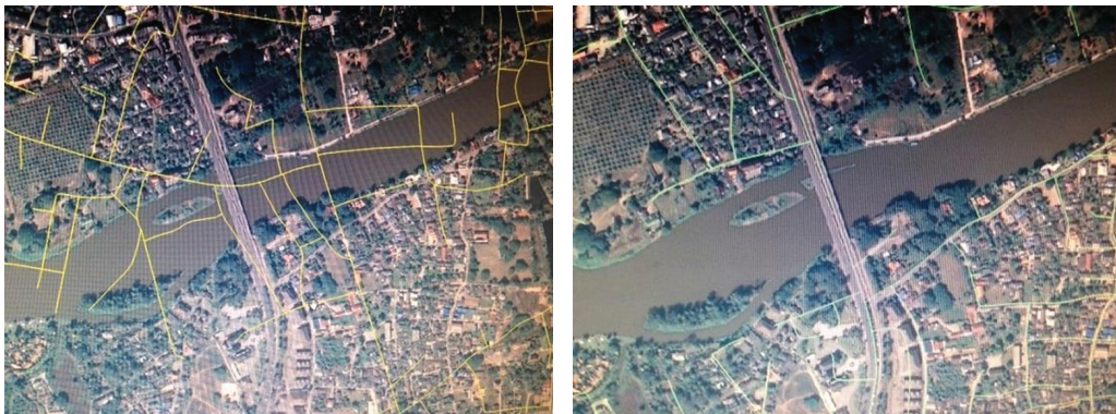
ภาพที่ ๑๒ การตรวจสอบความถูกต้องทางเรขาคณิต (Geometry Correction) และความสมบูรณ์ของการเชื่อมโยง (Topology) ของข้อมูล
