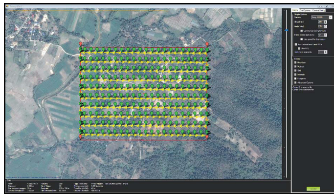
ภาพแสดงจำนวนฐานบินในแต่ละแนวกบินและการครอบคลุมพื้นที่ของการบินถ่ายภาพในพื้นที่ ๑ บล็อก
