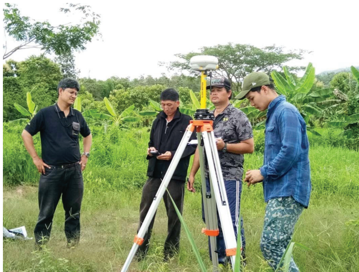
ภาพแสดงการรับสัญญาณที่จุดบังคับภาพภาคพื้นดิน
