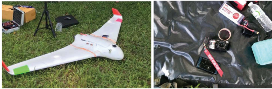
ภาพแสดงเครื่องบิน Delta Wing และกล้องถ่ายภาพ Sony A6000
