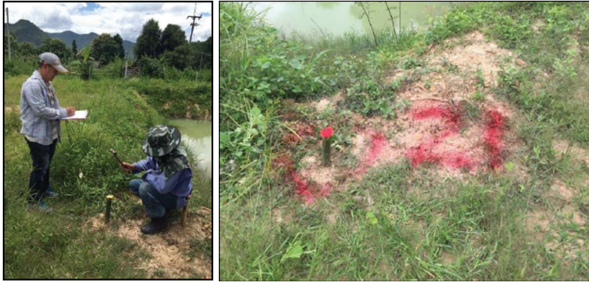
ภาพแสดงการวางตำแหน่งหมุดบังคับภาพภาคพื้นดินในพื้นที่จริงและพ่นสีเป็นจุดเป้าล่วงหน้า (Premark)
