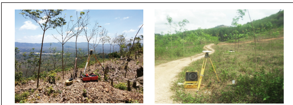
ภาพแสดงการรับสัญญาณดาวเทียม Rover Station
