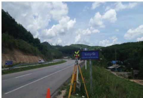
ภาพแสดงการปฏิบัติงานรังวัดวางโครงหมุดหลักฐานแผนที่
