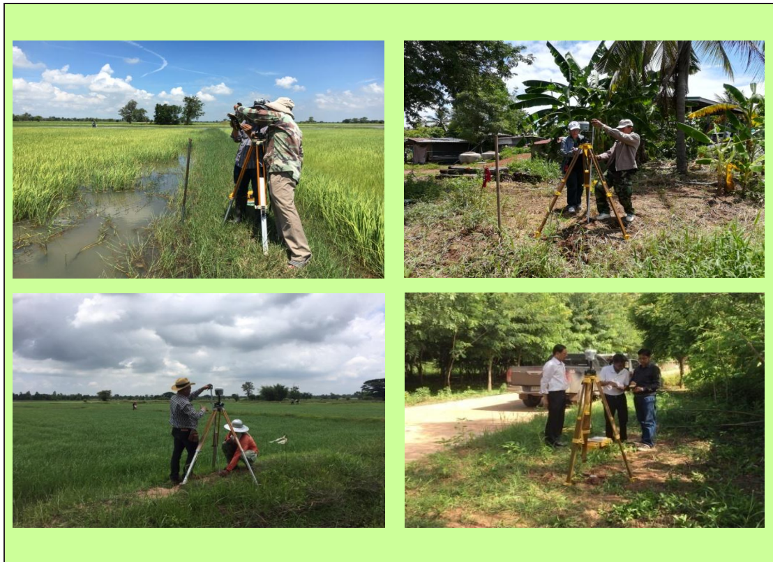
ภาพแสดงการรังวัดหมุดหลักฐานแผนที่โดยระบบดาวเทียม
