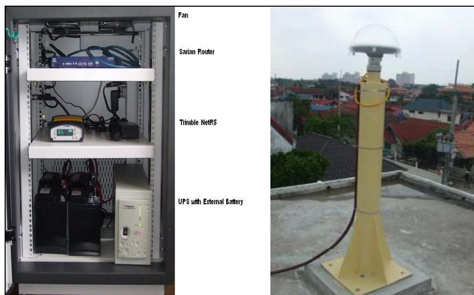
ภาพที่ 7 อุปกรณ์ประจำสถานีรับสัญญาณดาวเทียมอ้างอิง (Reference Station) ของกรมที่ดินในปัจจุบัน
