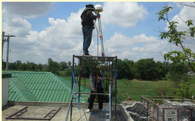
การทดสอบรับสัญญาณดาวเทียม 24 ชั่วโมง ณ ตำแหน่งก่อสร้างสถานีรับสัญญาณดาวเทียมอ้างอิง
